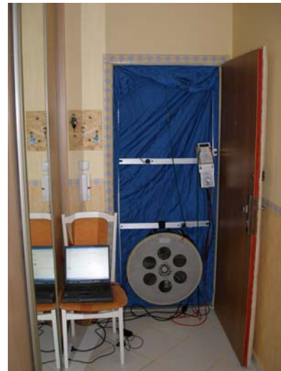
Obr. 2 – Zařízení blower-door test ve vstupních dveřích bytu
