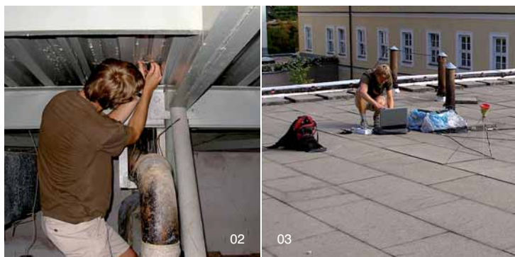
01 – 03 | Záběry z instalace čidel vnitřní povrchové teploty
